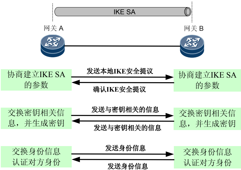
图 10-27 主模式下 IKEv1 阶段 1 的协商过程
