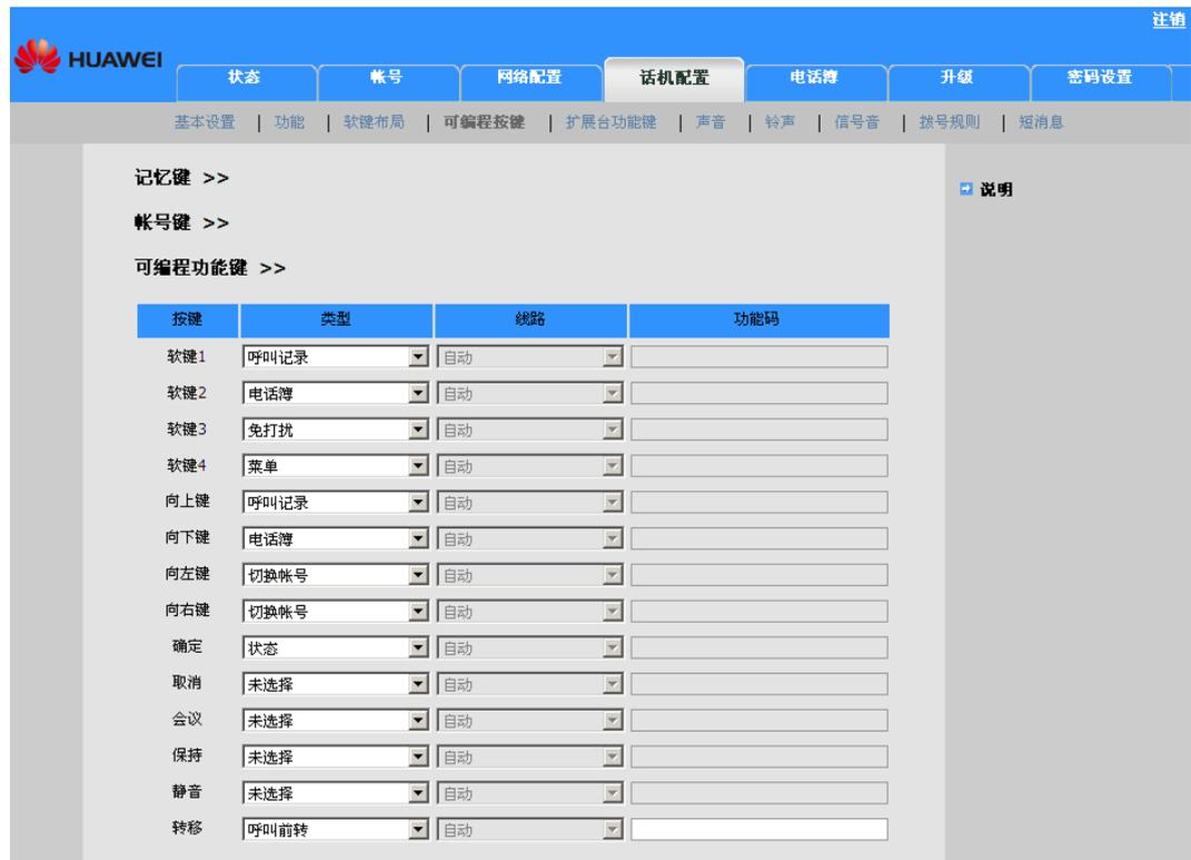
eSpace 7870&7850&7830 可进行编程的功能键有：4 个软键，“上/下/左/右”导航键，“OK”键，“X”键，“会议”键，“保持”键，“静音”键，“转移”键。
